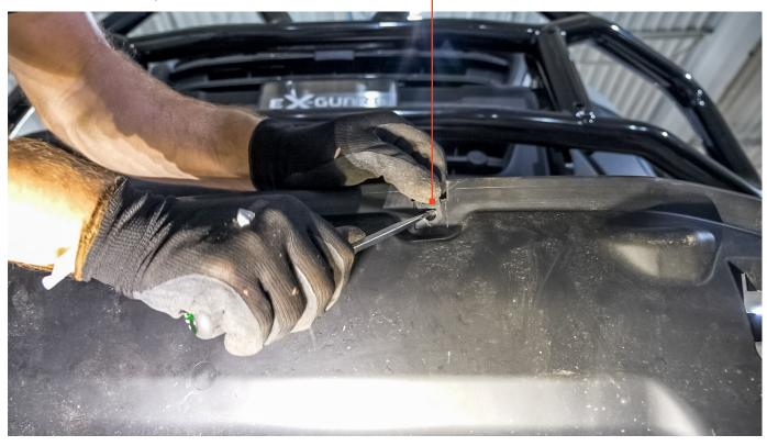
STEP 15: INSERT ON THE NEW SHROUD. POSITION AS SHOWN, AND USE 2 OF THE 10 BOLTS REMOVED FROM STEP 2 TO SECURE THE SHROUD TO THE BUMPER SKIN
