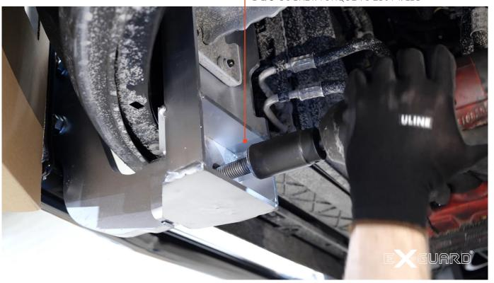
**STEP 16:** FINISH BY RE-FASTENING THE LOWER BUMPER SKIN WITH THE 6 SCREWS.
